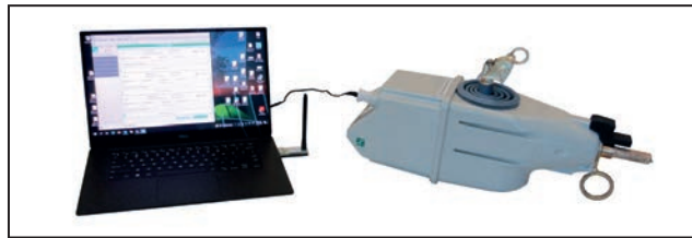
Figura 151. Colocación del reconector TripSaver II con relación al transceptor USB.
