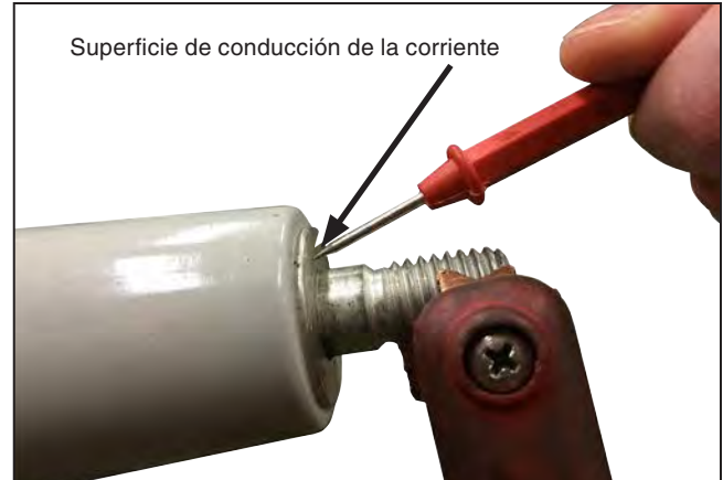
Figura 135. Tome la medición desde la superficie plana de conducción de la corriente de la boquilla.●
