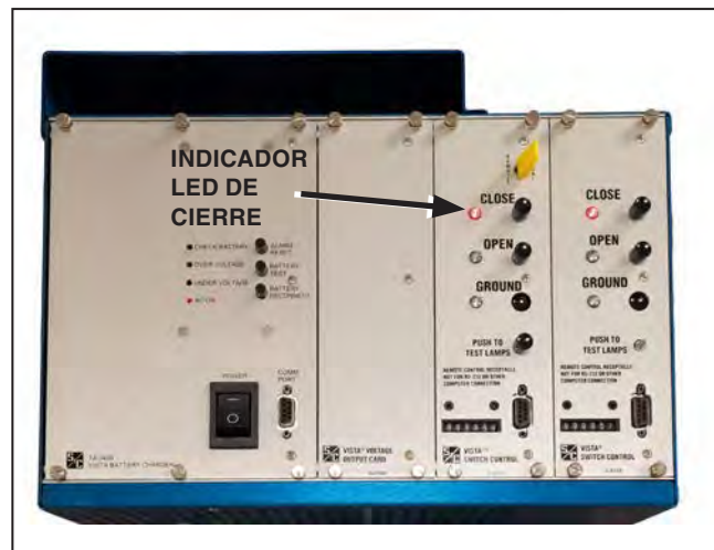
Figura 99. La indicación de CIERRE en el tablero de control del motor concuerda con la posición del moto operador.
