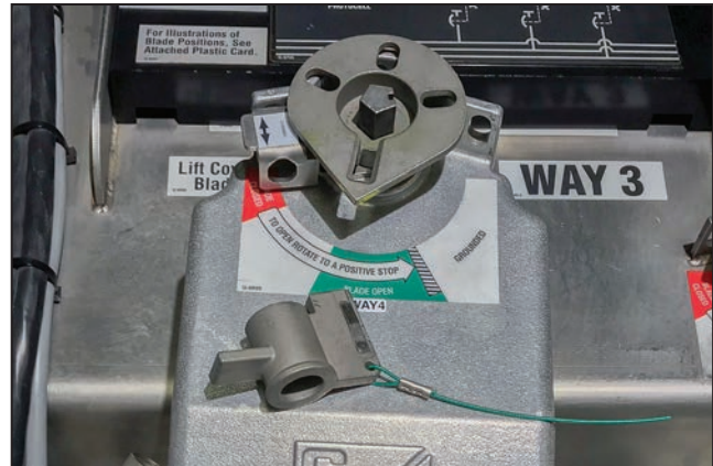
Figura 16. Selector de operación en la posición extrema izquierda.
