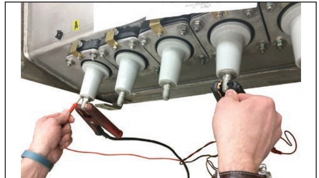
Figura 56. Conectando el dispositivo de medición de resistencia.●
