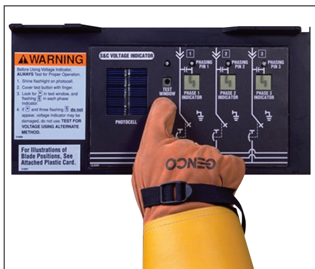
Figura 44. El indicador TENSIÓN está funcionando adecuadamente si aparece un punto en la mirilla TEST y un relámpago intermitente aparece en cada uno de los indicadores PHASE.
