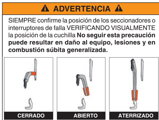
Figura 13. Confirme las posiciones de las cuchillas.
