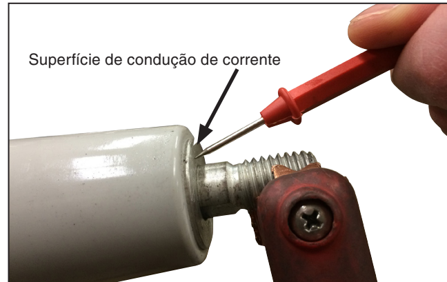
Figura 28. Faça a medição na superfície lisa de condução de corrente da bucha●
