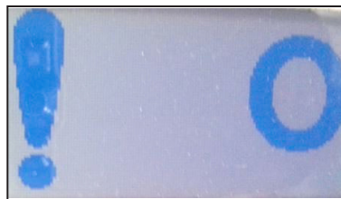
Figura 44. Tela Manutenção Imediata mostrando o interruptor a vácuo na posição Aberta .
