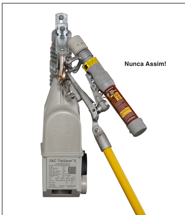
Figura 30. Abordagem incorreta de acoplamento.
