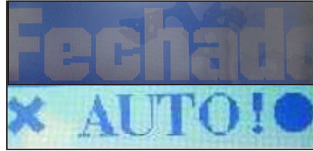
Figura 45. Ponto de exclamação indicando anormalidade na bateria.
