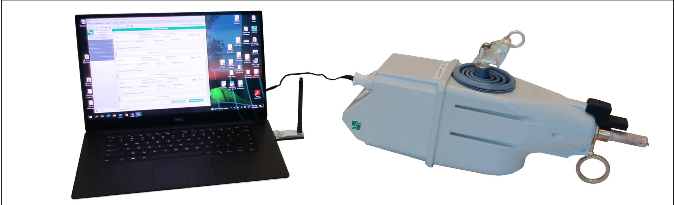
Figura 7. Instalación completa del reconector TripSaver II.
