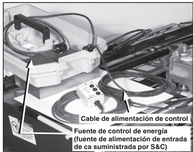
Figura 9. Conectando el cable de alimentación de control a la fuente de alimentación de entrada de ca suministrada por S&C.
