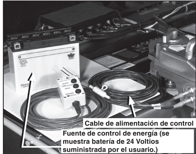
Figura 7. Conectando el cable de alimentación de control a la batería de 24 Voltios suministrada por el usuario.
