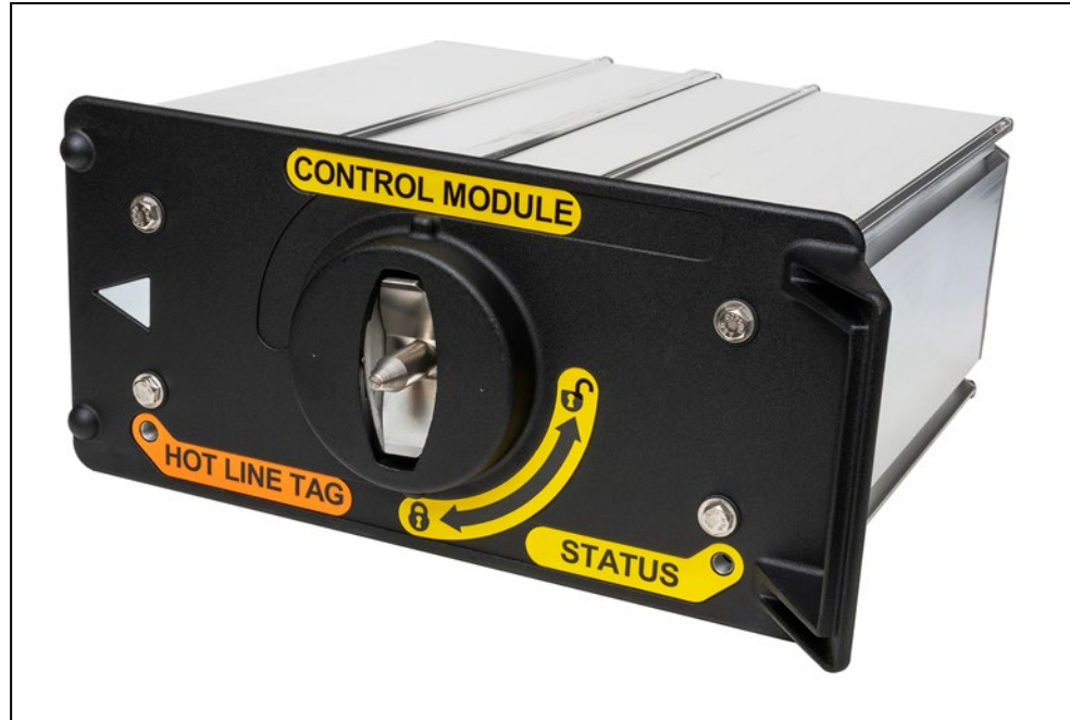
Figura 88. El módulo de control muestra el estado Ready (Listo) con un patrón de destello del indicador STATUS (ESTADO): destellando tres veces (½ segundo encendido, ½ segundo apagado) cada 30 segundos.
