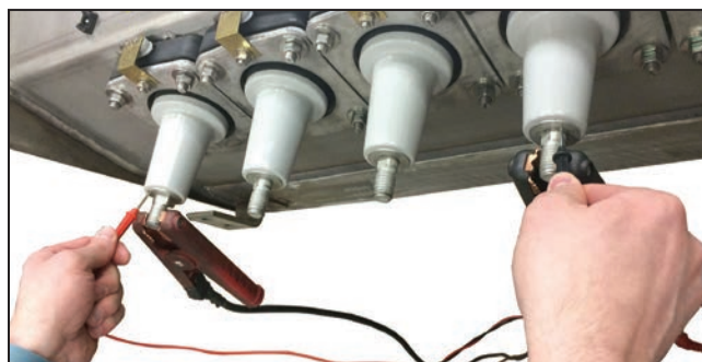
Figura 46. Conexão do dispositivo de medição de resistências●
