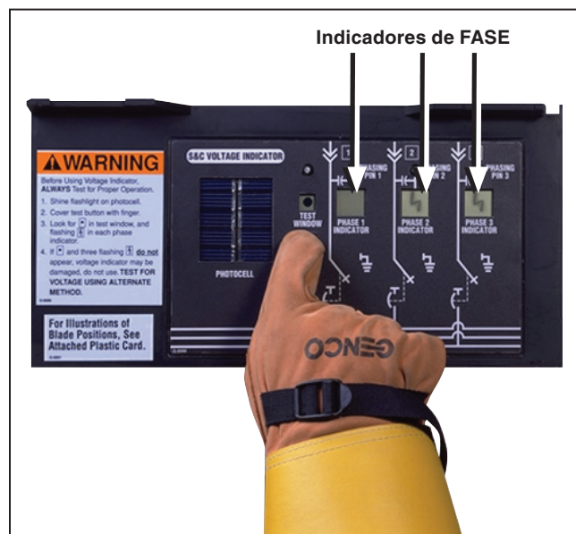
Figura 35. Se um ou mais indicadores de FASE não mostrar um símbolo de raio piscando durante o teste, o indicador de TENSÃO pode estar danificado. Teste a tensão usando um método alternativo.
