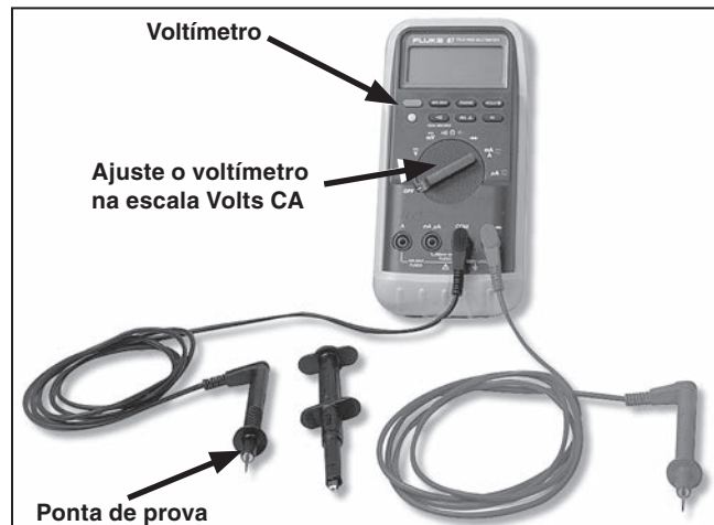
Figura 39. Voltímetro para o faseamento em baixa tensão.
