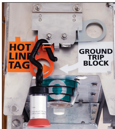
Figura 8. El modo Etiqueta de Línea Viva aplicado manualmente y “fijado”.
