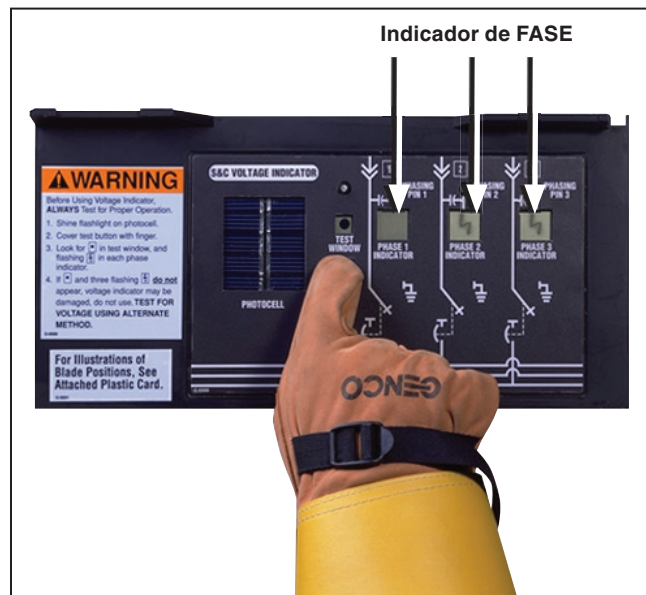
Figura 35. Si uno o más indicadores de FASE no muestran una señal de relámpago parpadeante durante la prueba, el indicador de TENSIÓN puede estar dañado. Pruebe la tensión utilizando un método alternativo.
