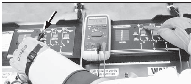
Figura 41. Midiendo la tensión fase a fase—Fase 1 a Fase 1.
