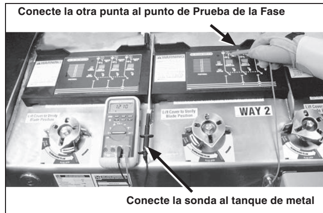
Figura 40. Conecte a tierra el voltímetro.
