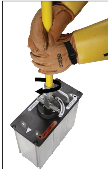
Figura 16. El aditamento de manipulación del módulo insertado en el seguro del módulo.
