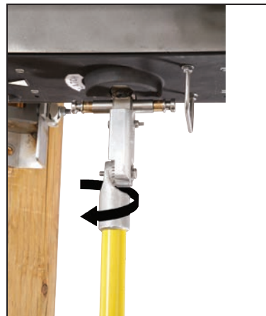
Figura 18. Cierre del módulo dentro de la base.
