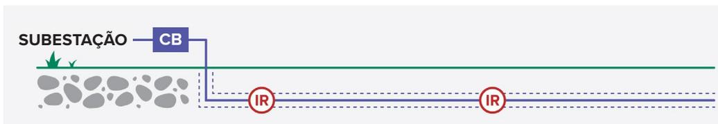
Os interruptores de falta IntelliRupter podem ser instalados em estilo pedestal sem afetar os dispositivos já existentes no sistema. Se ocorre uma falta temporária em uma linha subterrânea, o dispositivo realiza um teste de falta visando mitigar uma perda de fornecimento. O dispositivo também faz a aquisição de dados de eventos e disponibiliza esses dados para as inspeções de linha.
