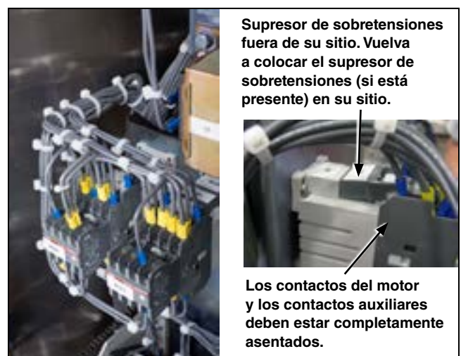
Figura 38. Cierre y abra los contactos del motor, los bloques de contactos auxiliares y los supresores de sobretensión situados detrás del panel lateral del operador.
