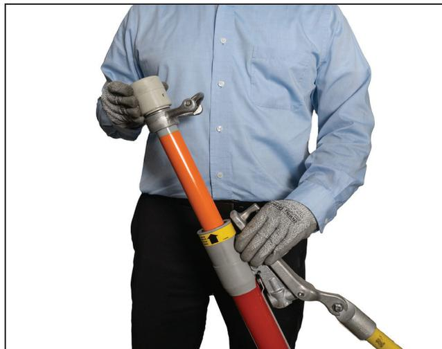
Figura 21. Reajustando una herramienta Loadbuster.
