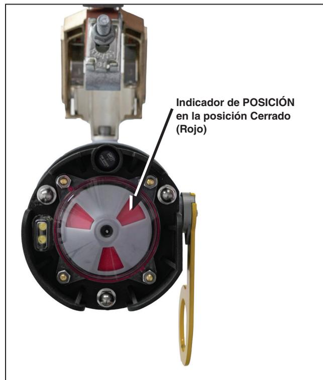
Figura 6. El interruptor en vacío en la posición Cerrado.
