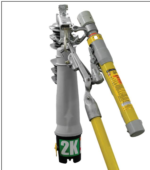
Figura 17. Un método incorrecto de sujeción.
