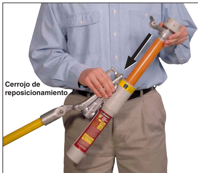
Figura 28. Reajustando una herramienta Loadbuster.
