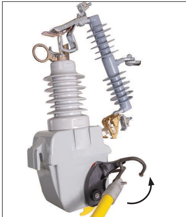
Figura 20. Girando la palanca de SELECCIÓN DE MODO hacia arriba a la posición del modo Auto.
