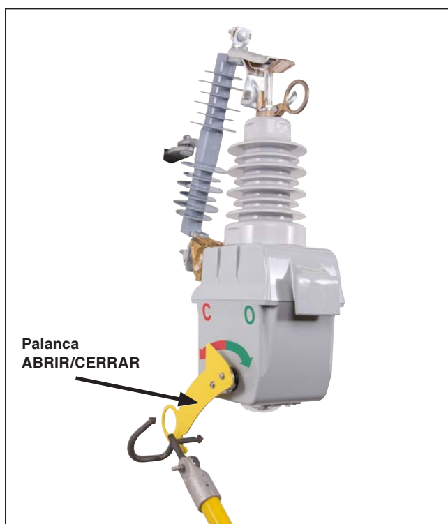
Figura 10. Abriendo el interruptor VacuFuse al empujar hacia arriba la palanca ABRIR/CERRAR.
