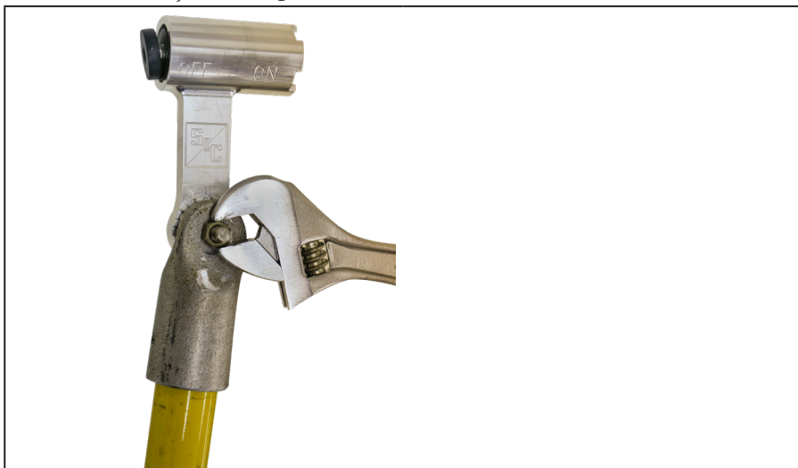
Figura 1. Instalando a ferramenta magnética em uma vara de manobra.
