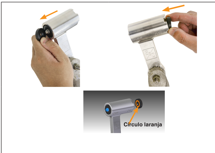
Figura 2. Mudança do ímã para o lado “ON” da ferramenta.
