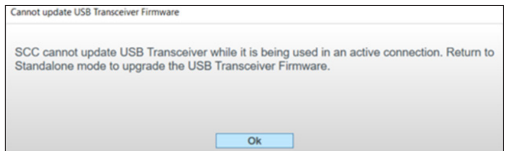
Figura 63. Caixa de diálogo informando impossibilidade de atualização enquanto o software de configuração em centro de serviços estiver em modo Connected e sendo usado em uma conexão ativa.
