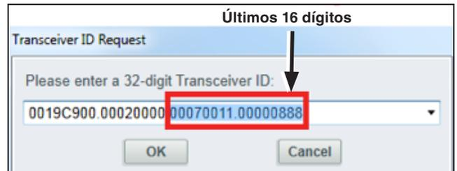
Figura 11. Digite os últimos 16 dígitos do ID do transceptor na caixa de diálogo Transceiver ID Request.
