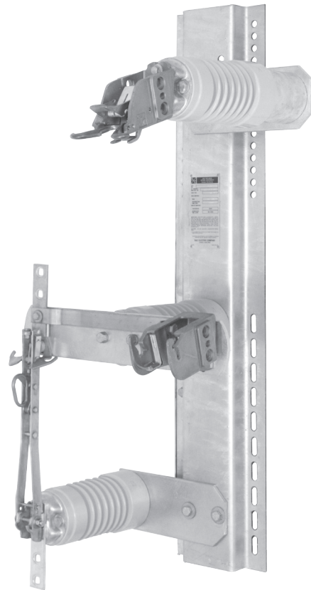
Circuito de puenteo abierto (sin fusible), con navaja desconectadora de puenteo para restaurador y Seccionador Loadbuster Disconnect de S&C del lado de la fuente cerrado.
