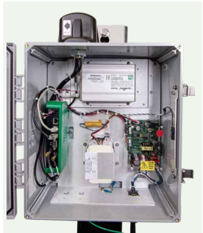
FIGURA 6. Gateway de Comunicação do TripSaver II
